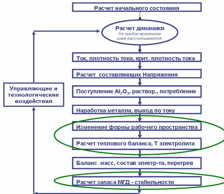
Рис. 2. Порядок взаимодействия основных блоков динамической модели
