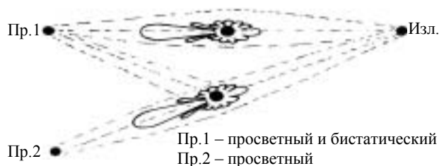
Рис. 1. Схема совместной реализации низкочастотных методов просветной и бистатической гидролокации
