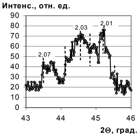
Рис. 6. Субструктура рентгеновского спектра с образца FeNi-6 ( $C_{Fe} = 77,7$  %) в диапазоне углов отражения  $2\Theta = 43 - 46$  град
