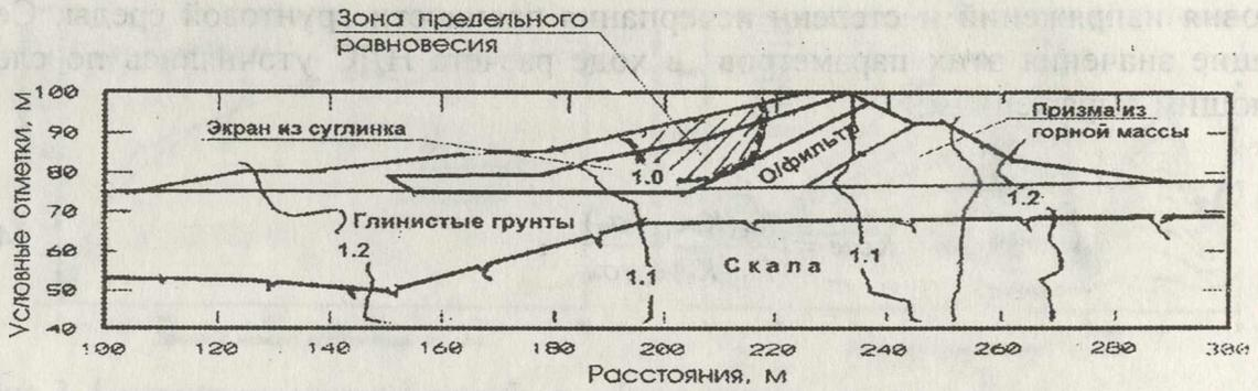
Рис 4. Распределение  $k_{saf}^s$  в поперечном сечении плотины на ПК8.10
