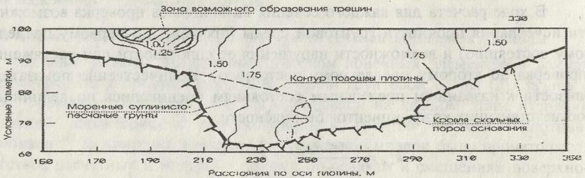
Рис.5. Распределение  $k_{saf}^t$  в продольном сечении плотины на участке ПК7-ПК9
