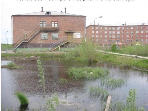
Рис. 4. Быстро прогрессирующий термокарст
