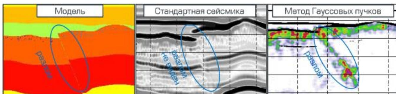
Рис. 1. Пример выделения разлома по рассеянным волнам методом гауссовых пучков
