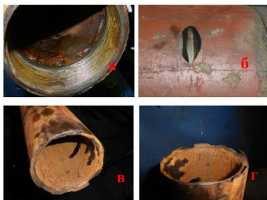
Рис. 1. Износ корпуса и гильзы ГС на 70 % (а); промыв корпуса ГС (б); «перерезание» корпуса ГС (в, г)
