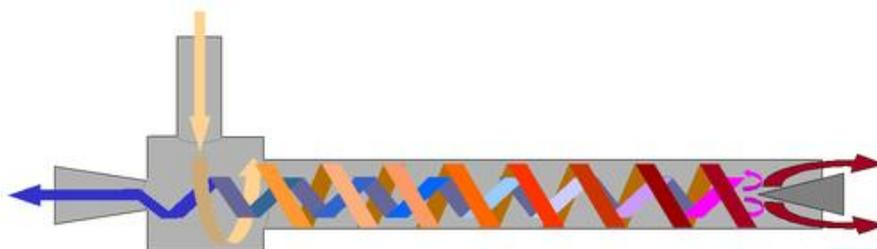
Рисунок. Схема трубки Ранке
