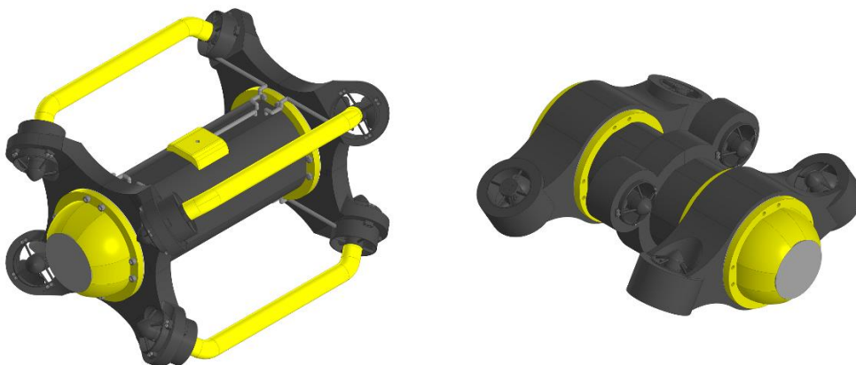
Рисунок 4 – Варианты конструктивного исполнения подводного дрона
