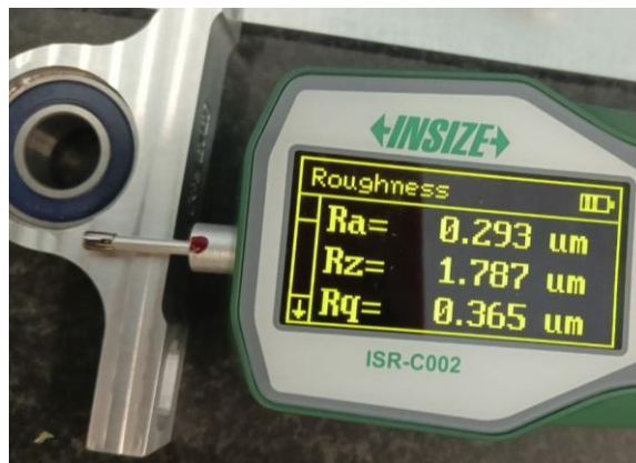
Рисунок 3– Результаты замера шероховатости для подшипниковой опоры
