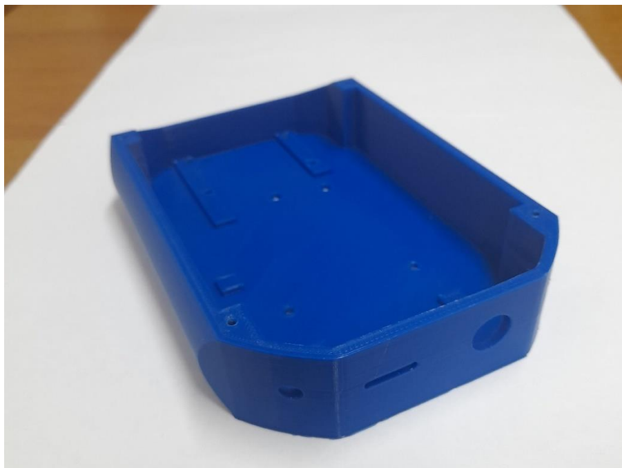
Рисунок 2. Пример распечатанной корпусной детали
