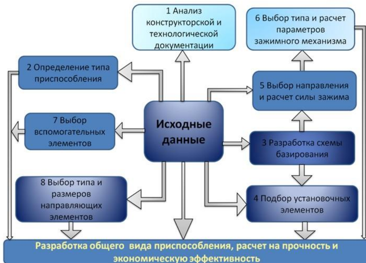
Рисунок 1. Последовательность проектирования технологического приспособления
