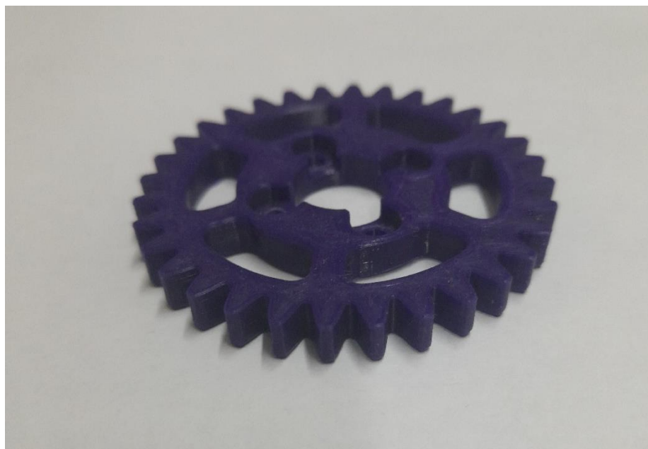
Рисунок 1. Пример напечатанного зубчатого колеса
