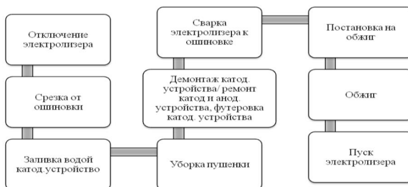
Рисунок. Схема технологического процесса ремонта электролизёров
