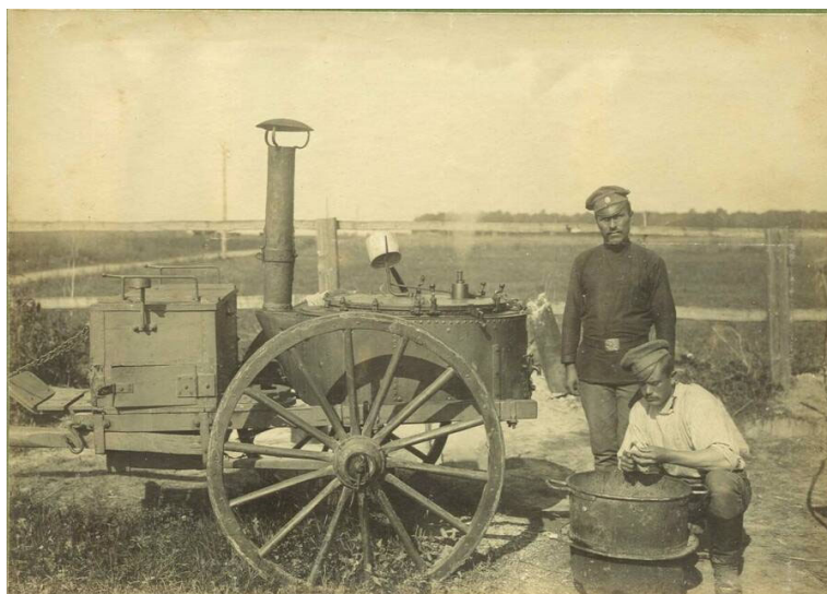
Рис. 1. Двухколесная кавалерийская военно-походная кухня системы Бруна (Криштофа), Первая мировая война
