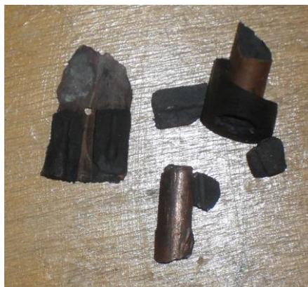
В ходе проведения эксперимента установка заработала не сразу, так как разрядная трубка была недостаточно изолирована (была вставлена в резиновый шланг) от воды и от кольцевого электрода. При подаче напряжения от конденсаторной батареи разрядная трубка разлеталась на мелкие части. Но это было исправлено, когда угольный электрод был помещён в стеклянную трубку.
