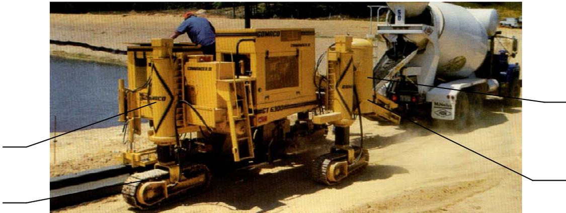
Рис. 1. Бордюроукладчик фирмы "Gomaso": 1 – шасси; 2– скользящая опалубка; 3 – приемный лоток; 4– телескопические балки с гидроцилиндрами
