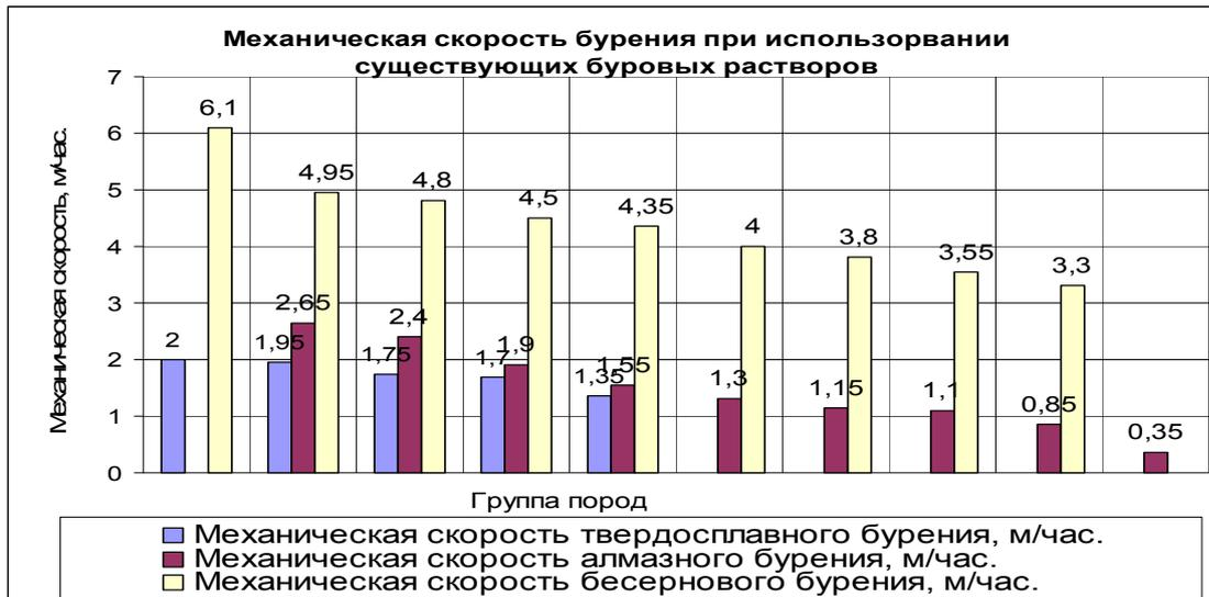
Рис. 2. Механическая скорость бурения при использовании существующих буровых растворов
