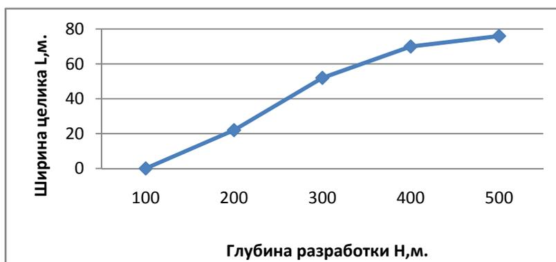
Рис. 1. Зависимость ширины целика от глубины разработки
