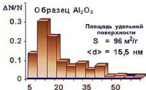
Рис. 5. Распределение по размерам частиц оксида алюминия электровзрывного синтеза, используемого в качестве модификатора
