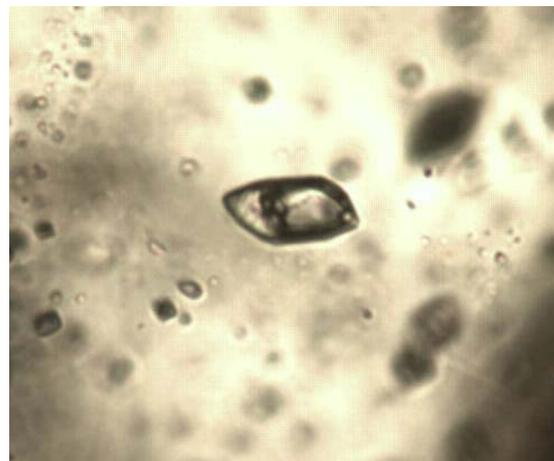
*Рис. 2. Двухфазное углекислотное первичное включение (температура  $-90\text{ }^{\circ}\text{C}$ ). Жидкая фаза углекислоты замерзла, увеличение  $\times 80$*
