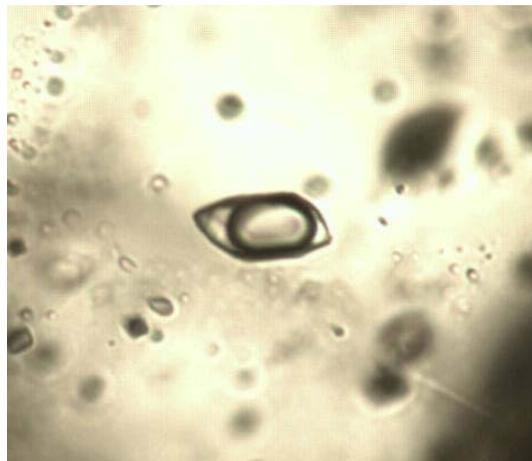
*Рис. 1. Двухфазное углекислотное первичное включение (комнатная температура), увеличение  $\times 80$*
