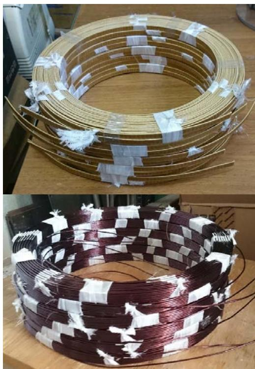
*Рис.3 - Секции индукторов, слева - основной, справа – дополнительный*
