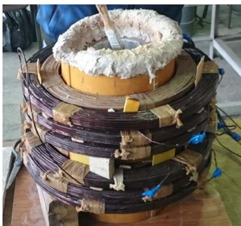
*Рис.4 - Индукционная тигельная печь с МГД-вращателем*
