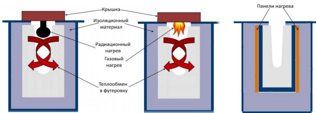
*Рис.1-Виды предварительного разогрева желобов*
