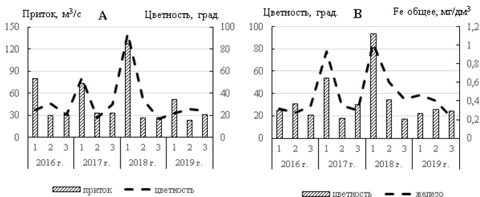
Рис. 2. Изменение цветности с притоком воды (А) и содержанием общего растворенного железа (В) в Сурском водохранилище в период 2016-2019 гг. (1 – весна, 2 – лето, 3 – осень)
