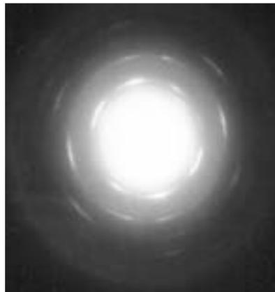
*Рис. 2. Картина микродифракции кристаллических образований, находящихся внутри бактериальной клетки*
