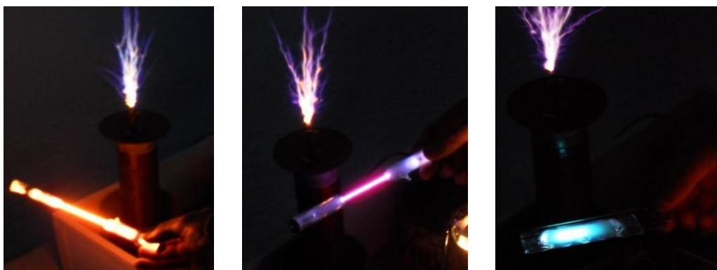
Рис. 3. Тлеющие разряды от спектральных трубок
