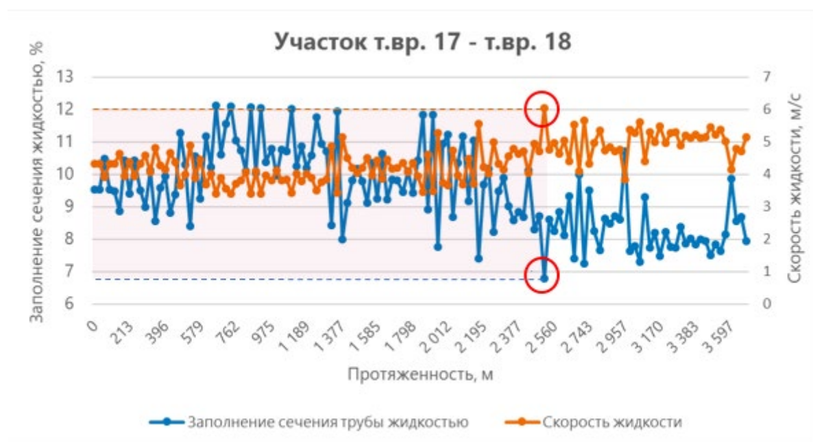
Рис. 1. График зависимости скорости жидкости от процента заполнения трубы жидкостью на участке «т. вр. 17 – т. вр. 18»
