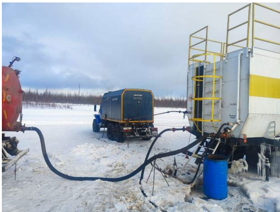
Рис. 5. Процесс подогрева пластовой воды
