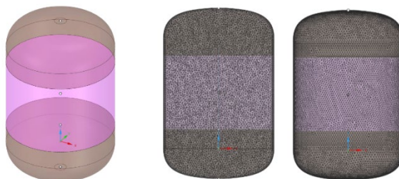
Рис. 1. Геометрия расчётной области и фрагменты расчётной сетки
