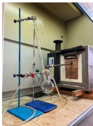
Рис. 4. Лабораторный стенд: а – нагревающий элемент стенда; б – установка охлаждения и конденсирования паров УВ и воды
