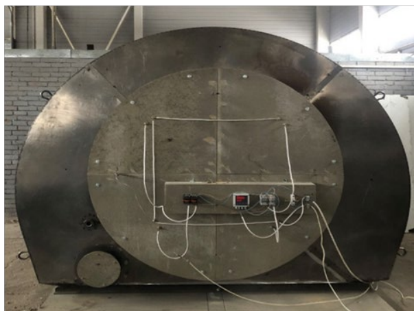
Рис. 4. Экспериментальный стенд газоотвода ГТД АЛ-31СТ со смонтированным на нём БСТИ
