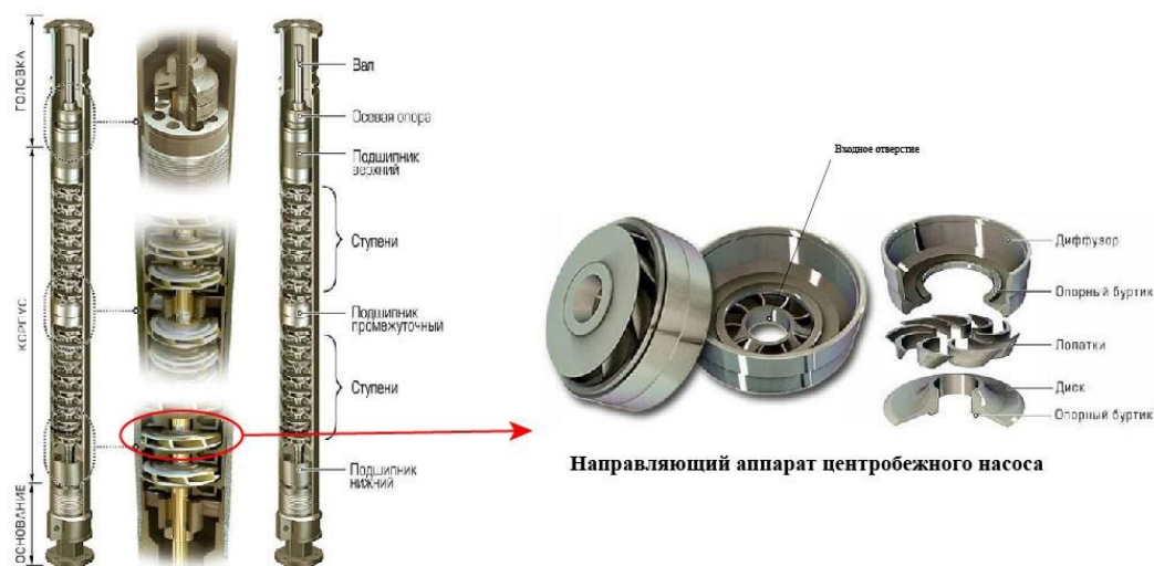
Рис. 2. Конструкция насосного модуля УЭЦН
