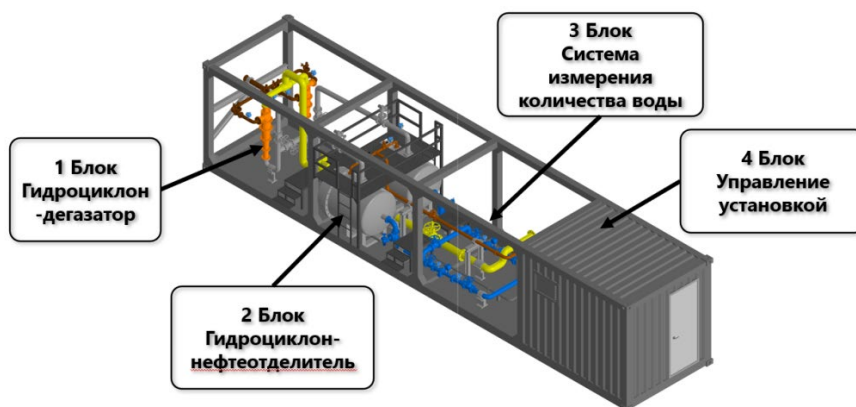
Рис. 4. Блочное исполнение мобильной установки предварительного сброса воды
