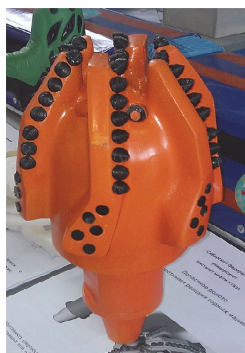
Рис. 5. Буровое долото с поворотными резцами
