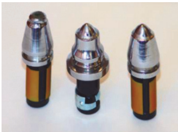
Рис. 3. Режущий инструмент горных машин
