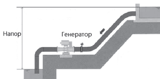
Рис. 2. Примерная схема установки микро-ГЭС
