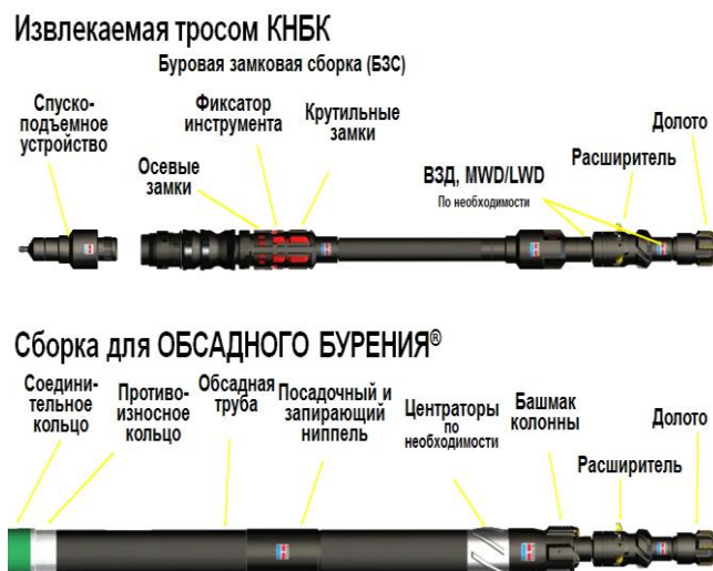
Рис. 1. Извлекаемая тросом КНБК и сборка для обсадного бурения [3]
