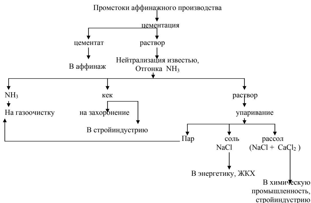
Рис.1. Действующая схема утилизации промышленных стоков аффинажного производства в ОАО «Красцветмет»
