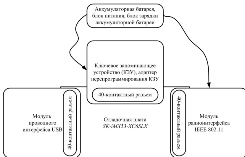
Рис. 2. Структурная схема отладочного комплекса
