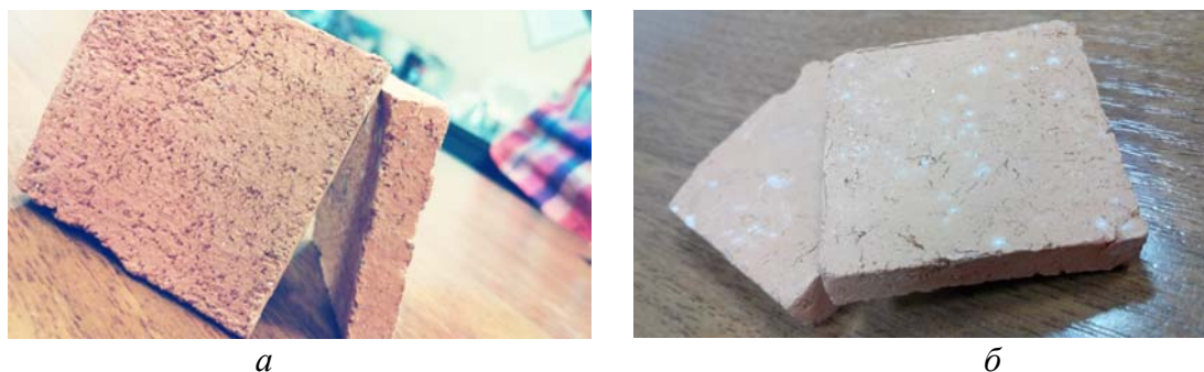
Рис. 2. Образцы керамических материалов с добавкой витерита (а) и без добавок в шихту (б)
