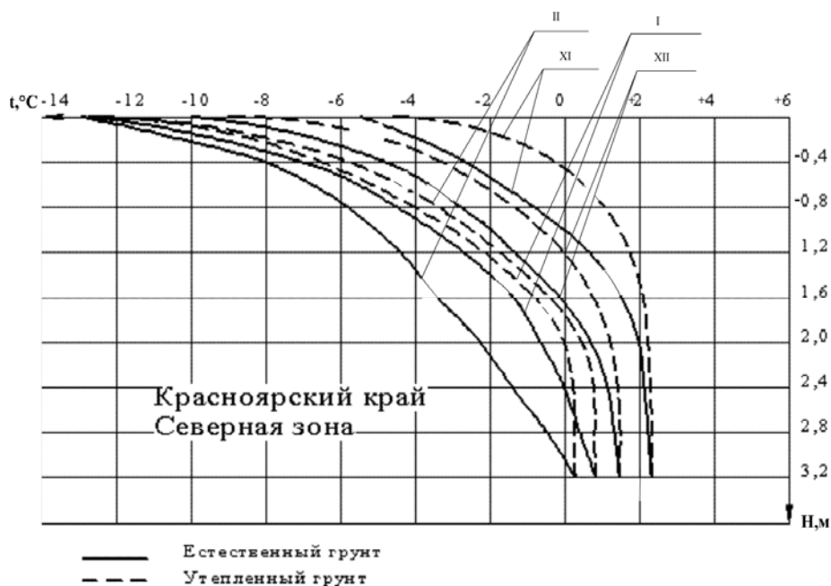
Рис. 3. Распределение температуры суглинка по глубине залегания для зимних месяцев года XI – ноябрь, XII – декабрь, I – январь, II – февраль в условиях естественного залегания грунта, утепленного карбамидным пенопластом
