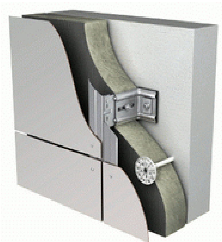
Рис. 2. Фасадные системы Краспан с применением композитных панелей «Краспан-AL», «Краспан-ST». Способ крепления: заклёпка
