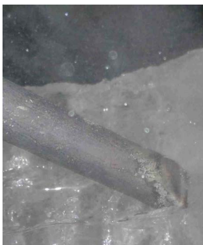
Рис. 1. Вариант рабочего органа для термо-механического разрушения снежно-ледяного покрытия автомобильной дороги
