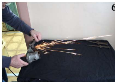
Рис. 19. Искровой метод определения химического состава стали
