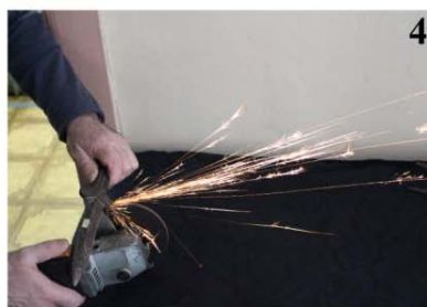
Рис. 19. Искровой метод определения химического состава стали
