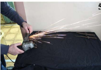
Рис. 19. Искровой метод определения химического состава стали
