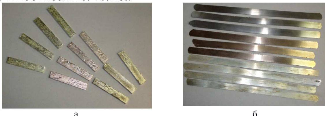
Рис. 2. Слитки (а) и прокатанные полосы (б) золота 585 пробы зелёного, красного и белого цветов
