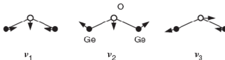
Рис. 2. Схематическое изображение нормальных колебаний квазимолекулы \text{Ge}_2\text{O} [2, 3]
