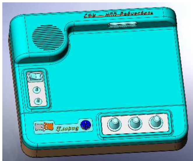
Рис. 3. Лабораторная станция «Глория»: а) макетный образец с разработанным ВИ – осциллографом; б) дизайнерская проработка корпуса с наименованиями организаций-разработчиков, предназначенная для его изготовления на 3D-принтере
