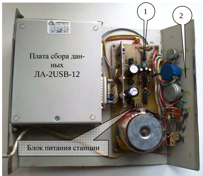
Рис. 2. Состав макетного образца лабораторной станции «Глория» (вид на макет снизу)
