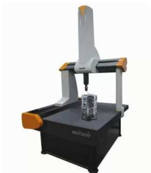
Рис. 3. Вертикальная (слева) и порталная (слева) КИМ
