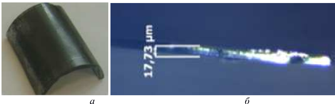
Рис. 4. Кварцевая пластина с покрытием, полученном при использовании 3 мас. % раствора поливинилового спирта, толщиной 17,73 мкм: а – фотография; б – микрофотография, \times 900
