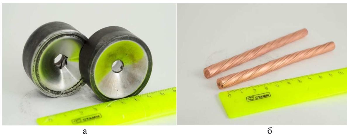
Рис. 2. Типы матриц, используемых при горячей экструзии (а) и внешний вид прутков после выдавливания через матрицу с винтовыми канавками (б)
