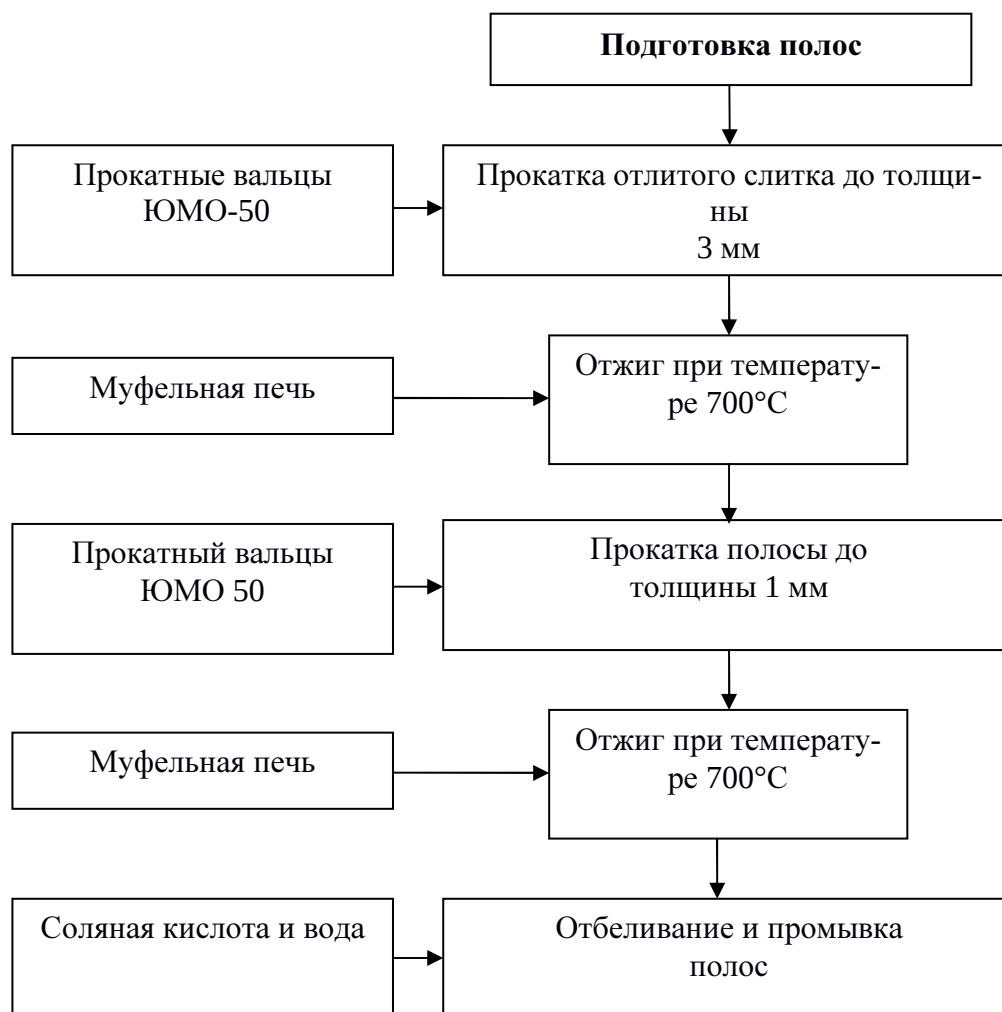
Рис. 3. Схема подготовки пластин перед сборкой композитного пакета
