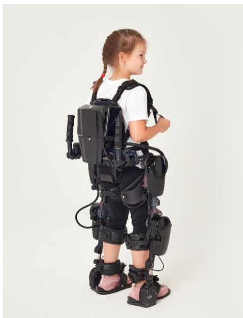
Рисунок 3. Детский вертикализатор с интеллектуальной системой тренировки с биологической обратной связью, с механотерапией нижних конечностей «С1»
