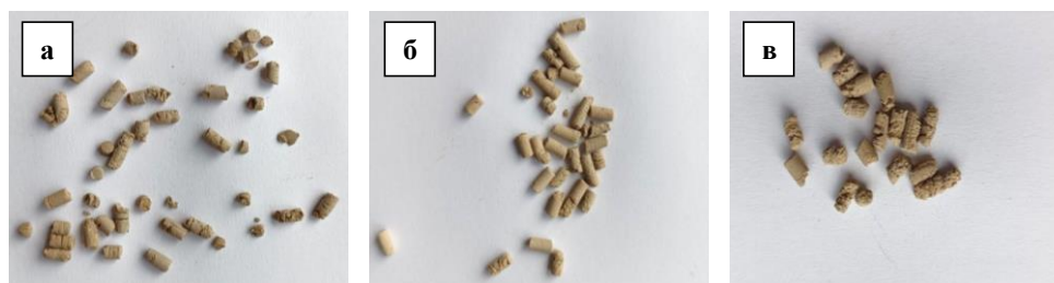
Рисунок 3. Фотографии гранулированных сорбентов со связующим на основе летучей золы: 20% ЛЗ-KOS (а), 30% ЛЗ-KOS (б), 30% ЛЗ-GAI (в)
