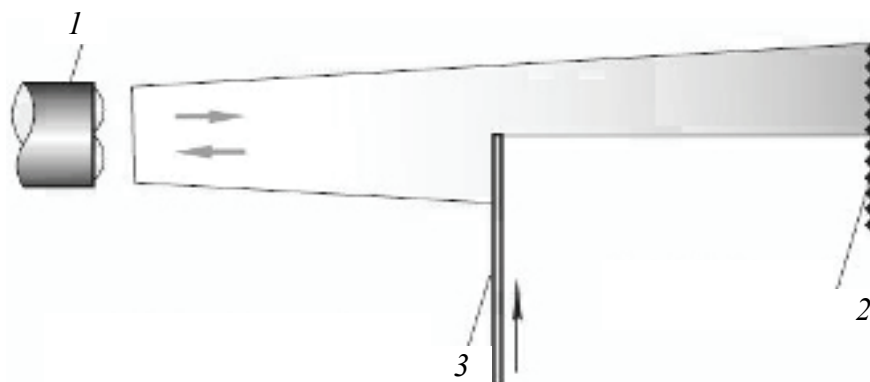
Рис. 6. Оптический датчик положения типа R: 1 – излучатель и приемник; 2 – отражатель; 3 – объект воздействия
