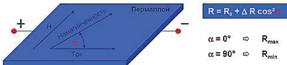
Рис. 16. Принцип действия магниторезистивного датчика перемещения
