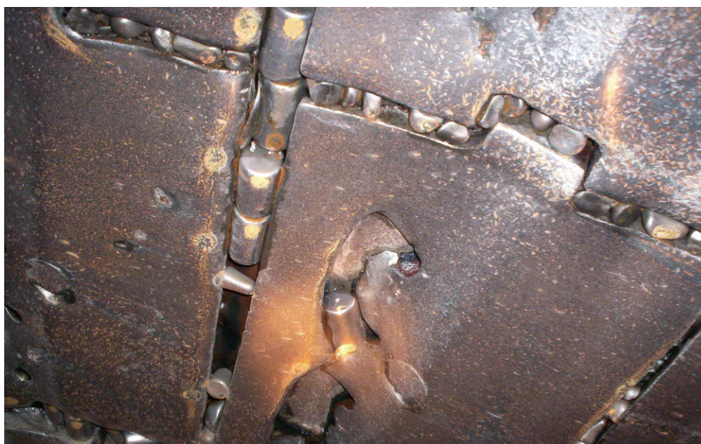
Рис. 2. Забивание разгрузочных решеток при работе домольных мельниц с применением в виде мелющих тел чугуных цильпессов производства РМБ
