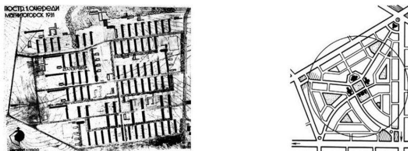
Рис. 2. Проект планировки Магнитогорска на 200 тыс. жителей. План первой очереди строительства, 1931, Э. Май, М. Стам и др. (слева); идеальная схема городского нейбохуда по К. Перри (справа)
