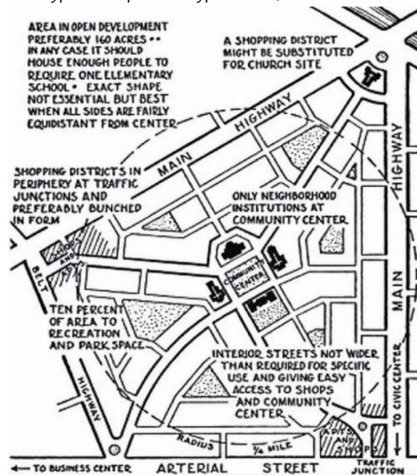
Рис. 11. Концептуальная схема нейборхуда, предложенная Кларенсом Пери в 1928 году. Прообраз планировочной единицы с внешним коммерческим контуром и внутренним общественным центром
