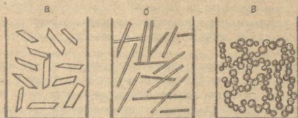
Рис. 8. Рыхлые структуры, образованные частицами различной формы а - листообразная форма частиц; б - палочкообразная форма частиц; в - изодиаметрическая форма частиц /шар или куб/.
