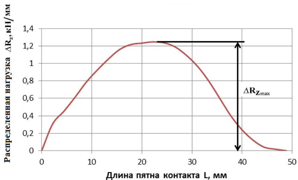
Рис. 10. Эпюра распределения нормальной реакции в пятне контакта эластичной шины при качении колеса по цилиндрической поверхности бегового барабана диагностического стенда диаметром 0,24 м (давление в шине – 0,21МПа)
