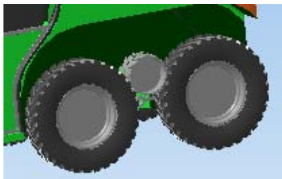
Рис. 3. Роликовый фрикционный привод ведущих колес проектируемого ТС
