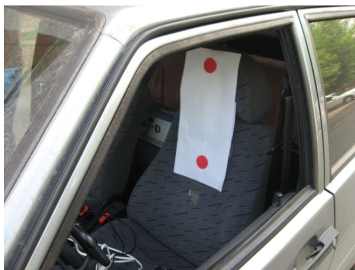
Рис. 8. Размещение экрана с красными метками на спинке водительского сиденья в фокусе первой веб-камеры
