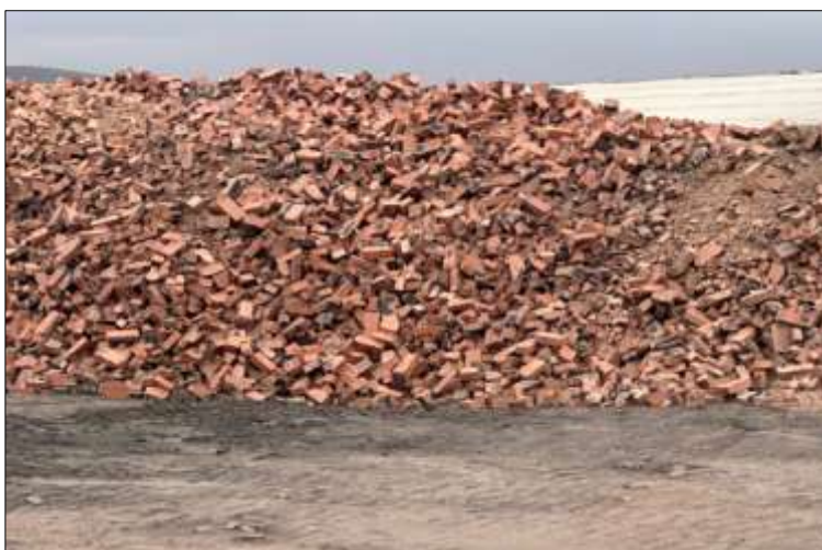
Рис. 2. Складирование боя керамического кирпича
