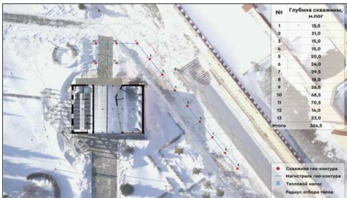
Рис. 5. Схема устройства геоконтура теплового насоса
