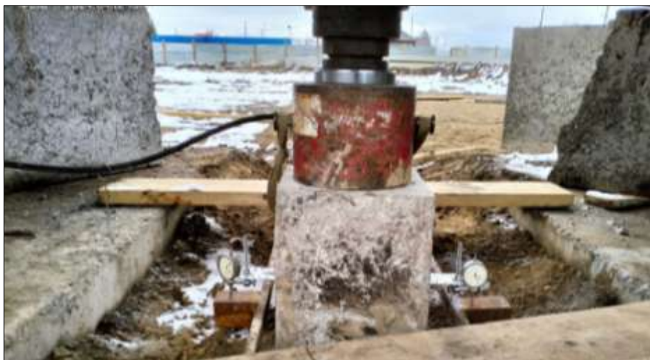
Рис. 3. Реперная система с индикаторами часового типа ИЧ-10 и домкратом ДГ200П150
