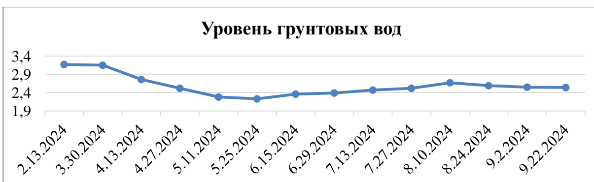
Рис. 3. График зависимости уровня грунтовых вод от времени года строящегося многоквартирного дома, расположенного по адресу: РХ, г. Абакан, ул. Трудовая, д. 84
