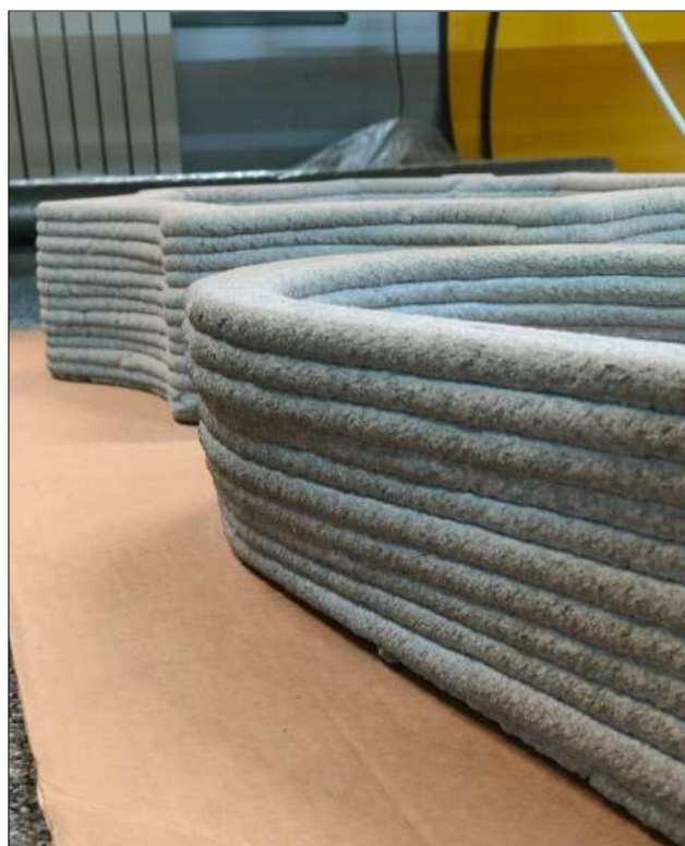
Рис. 2. Демонстрационные образцы компании АМТ, полученные при помощи 3D-печати
