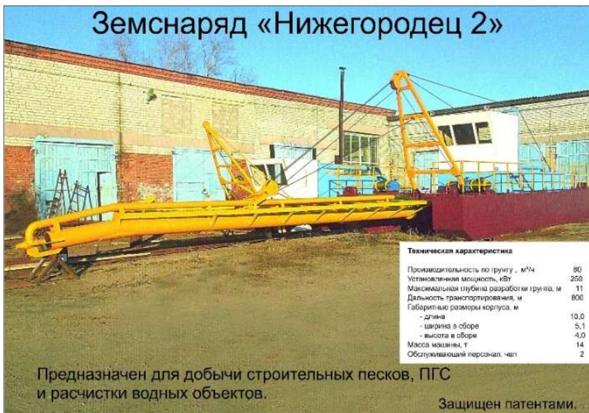
Рис. 3. Изображение и характеристики земснаряда «Нижегородец-2» [3]
