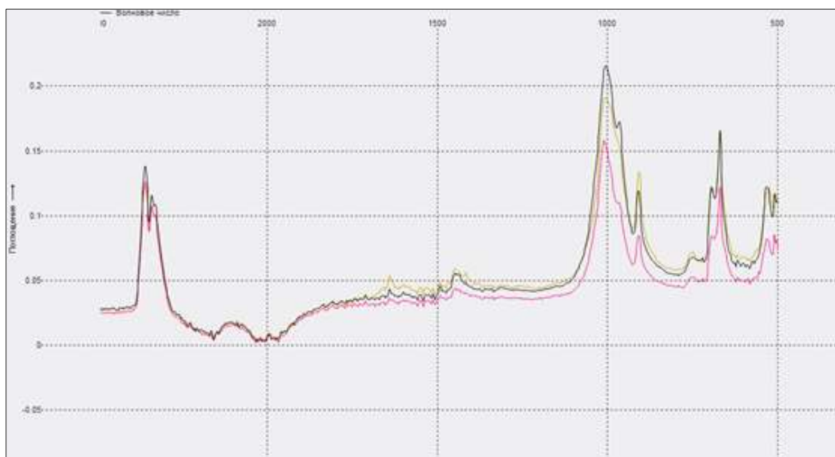
Рис. 1. ИК-спектры трёх марок СБС-полимеров различного состава
