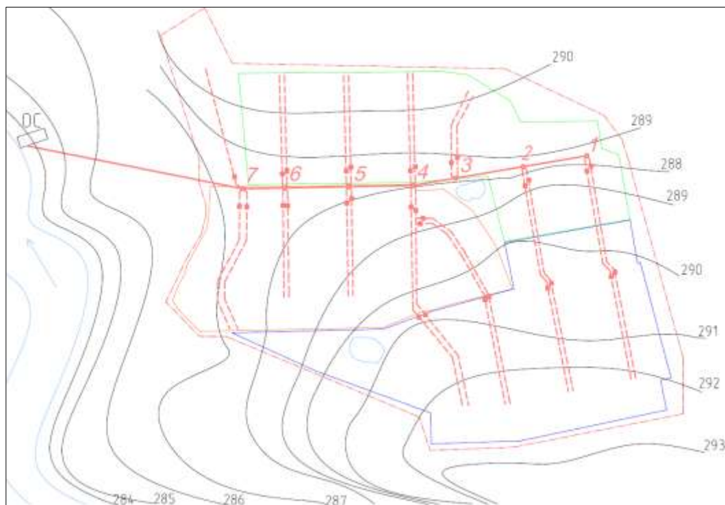
Рис. 1. Варианты схем водоотводящей сети поверхностного стока коттеджного посёлка: а – закрытая схема; б – комбинированная схема с лотками
