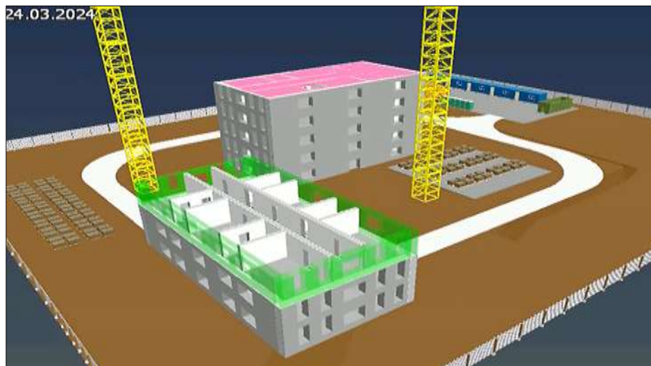
Рис. 2. Пример 4D-модели возведения сборно-монолитного каркаса [5]
