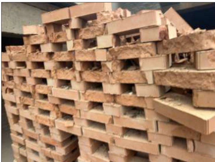
Рис. 1. Штабель керамического кирпича после обжига – технологический брак
