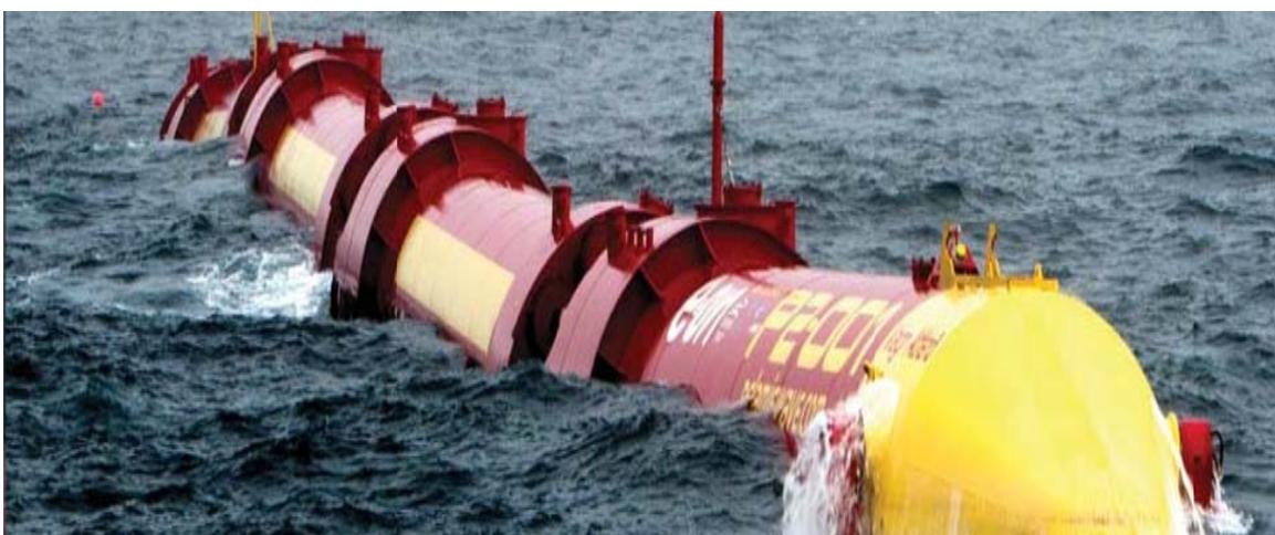
*Рис. 3. Волновой электрогенератор Pelamis Wave*
