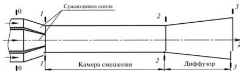
Рис. 3. Принципиальная схема газоструйного эжектора
