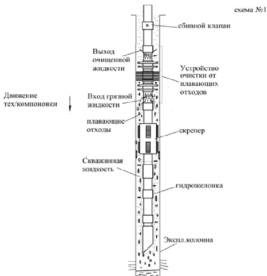
Рис. 1. Схема устройства для очистки забоя и ствола скважины от отложений и плавающих отходов
