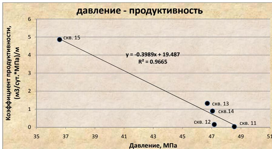
Рис. 3. Зависимость между удельной продуктивностью скважин и давлением сжатия трещин
