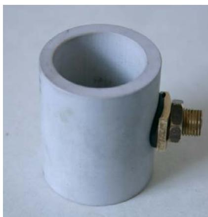
*Рис. 6. Внешний вид камеры, заполняемой исследуемым образцом*
