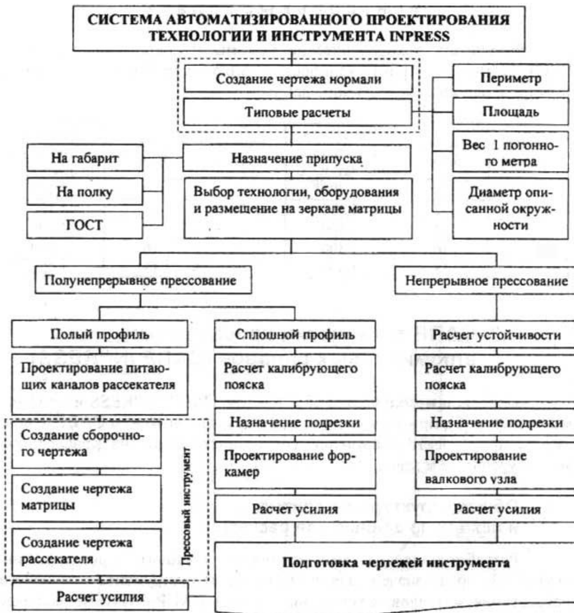
Рис. 2.12. Структурная схема системы проектирования INPRESS
