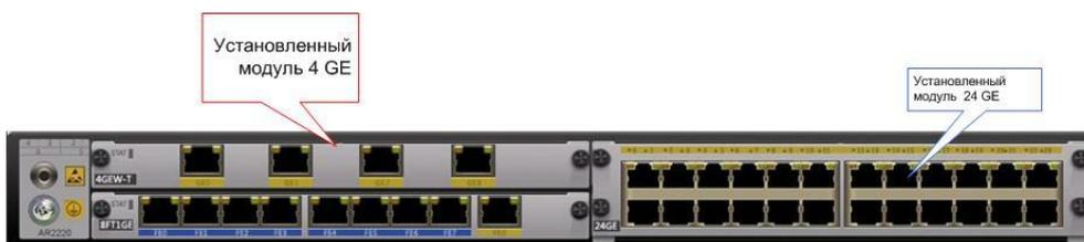
Рис. 4. Маршрутизатор после установки дополнительных модулей
