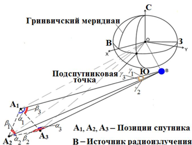
Рис. 3. Геометрические построения для метода определения координат ИРИ, основанном на использовании пирамиды
