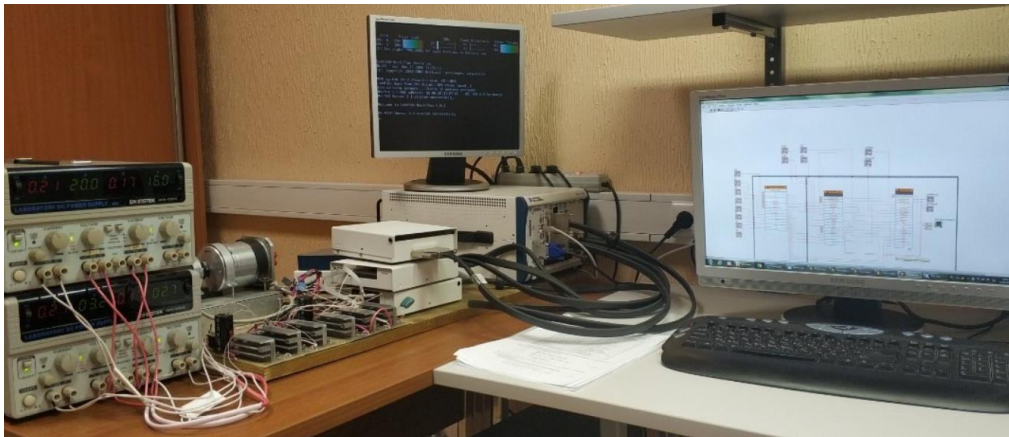
Рис. 3. Лабораторный комплекс для исследования и отладки законов управления ИДП
