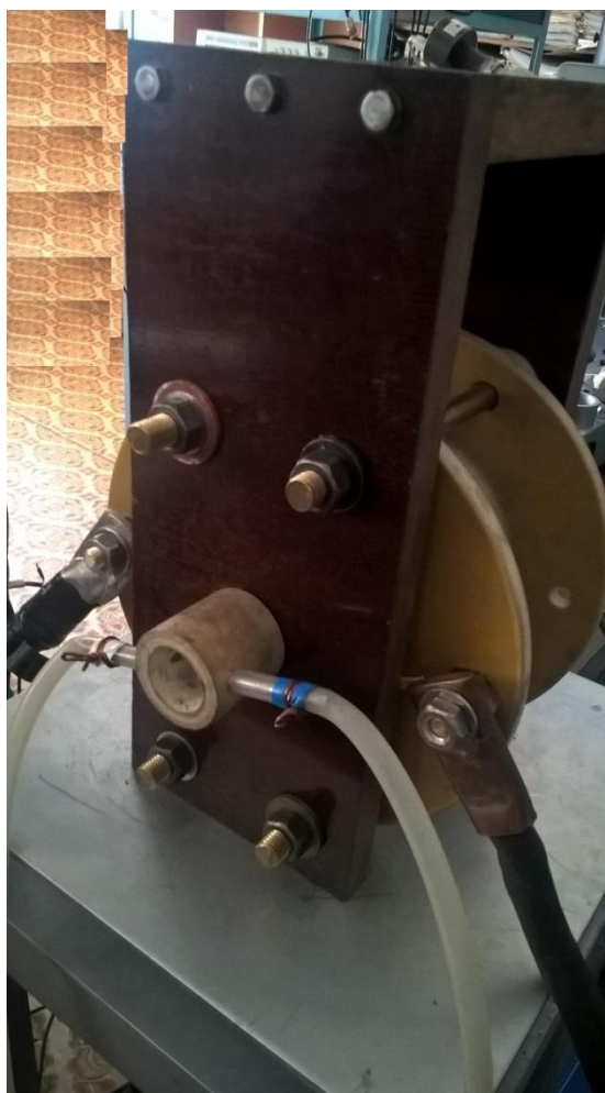
Рис. 2. Индуктор в сборе
