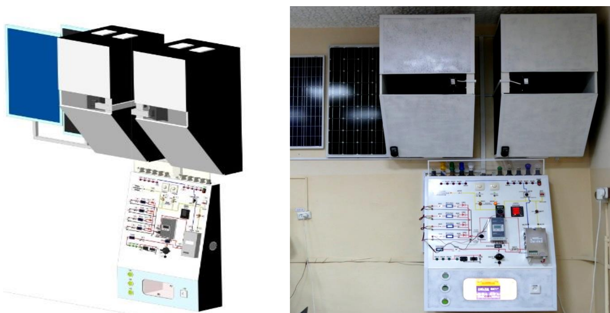
Рис. 1. Трехмерная модель (слева) и фотография стенда «Испытание солнечных панелей» (справа)
