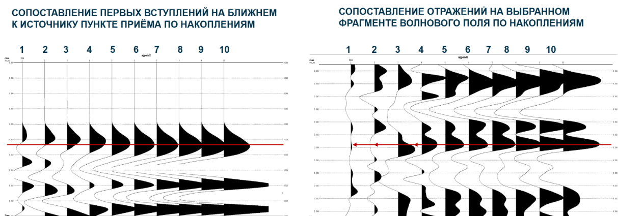
Рис. 2. Выборка трасс первых вступлений (слева) и выборка трасс в окне отражений (справа)
