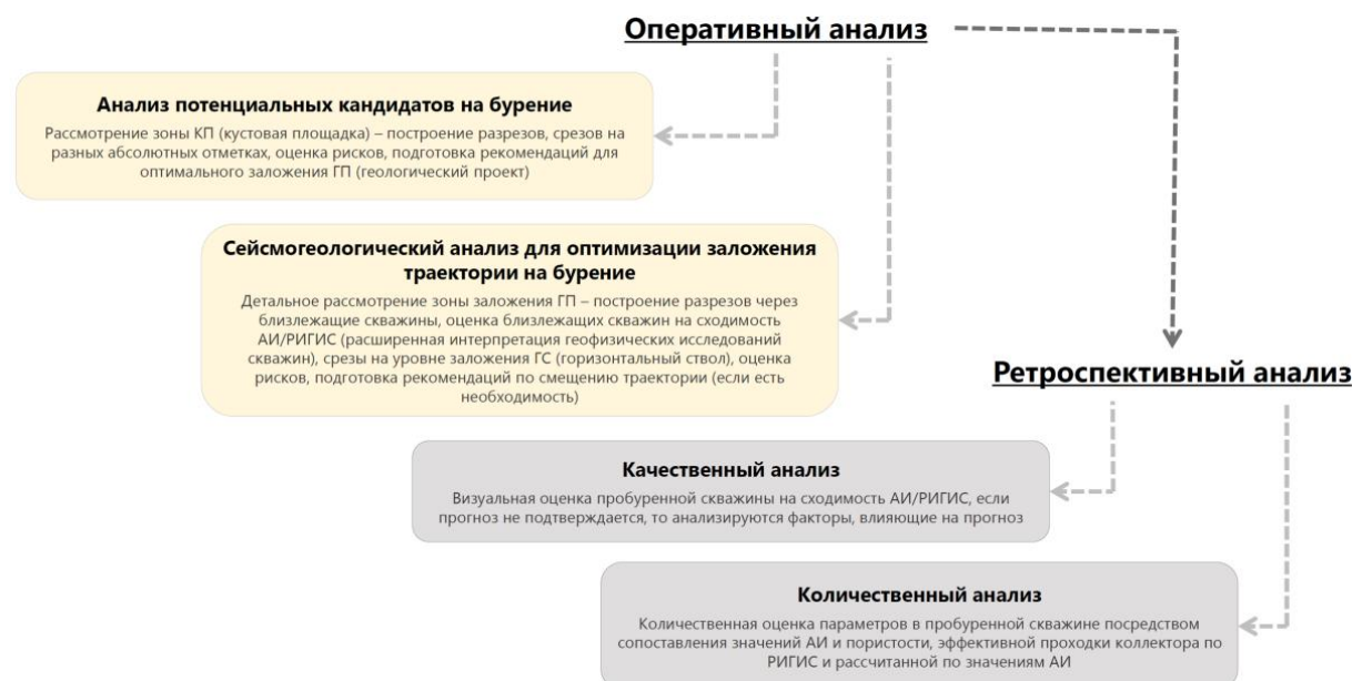
Рис. 4. Стадии работ в рамках сейсмогеологического сопровождения скважин
