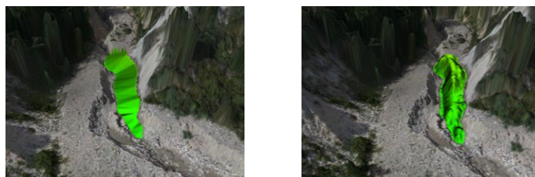
Рис. 3. 3D-изображение фрагмента ЦММ с поверхностью по наземным точкам контура насыпи и файл высот с выделенной поверхностью насыпи
