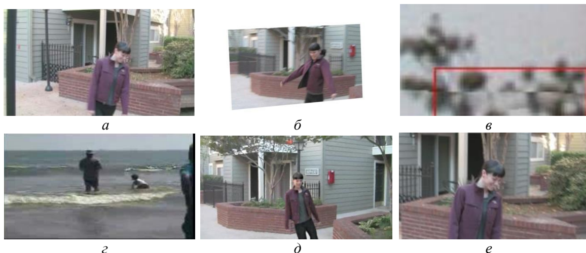
Рис. 1. Методы восстановления границ: а – оригинальное изображение; б – стабилизированное изображение без восстановления границ; в – применение мозаики для заполнения отсутствующих регионов; г – заполнение пустых областей и применение размытия границ; д – переориентация изображения к объекту интереса; е – масштабирование изображения
