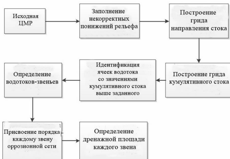
Рис. 1. Алгоритм определения водосборного бассейна реки
