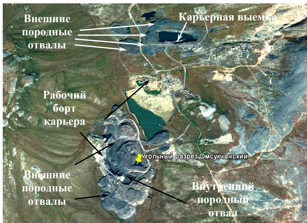
Рис. 4. Компоновочная схема горных работ на разрезе «Омсукчанский»
