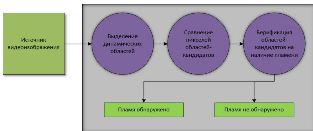
Рис. 1. Структурная схема алгоритма обнаружения пламени
