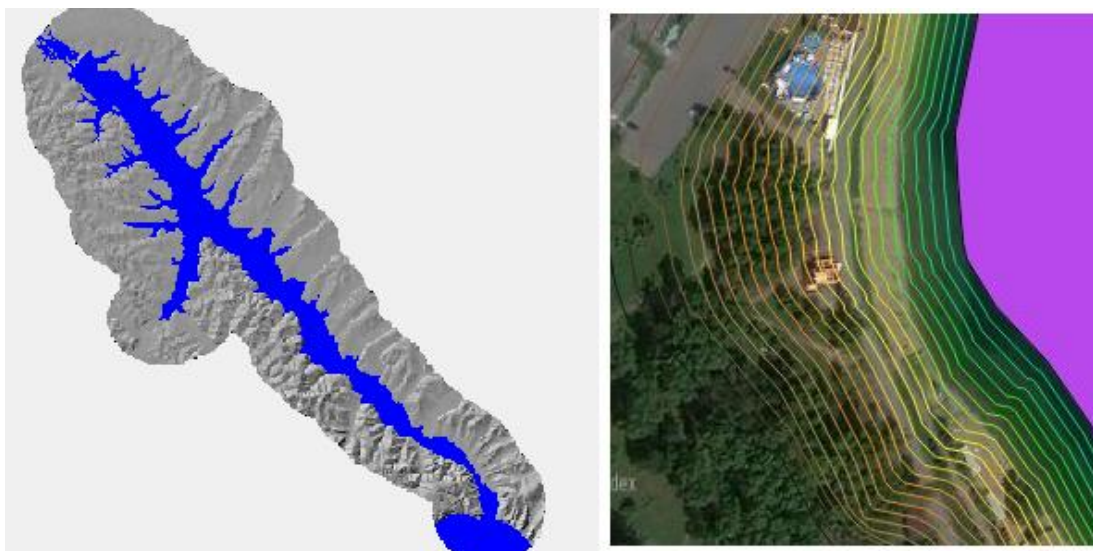
Рис. 2. Построение триангуляции на заданную область и пример возможного затопления при различных сценариях водности (Иркутское водохранилище). Изолинии построены через 20 см
