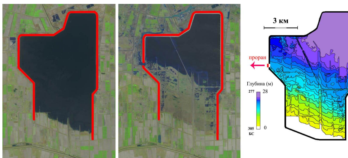
Рис. 1. Снимки Sentinel-2A Сардобинского водохранилища до (26.04.2020) и после (04.05.2020) аварии (красная линия – удерживающая воду дамба) в сравнении с батиметрией водохранилища, построенной на основе набора береговых линий
