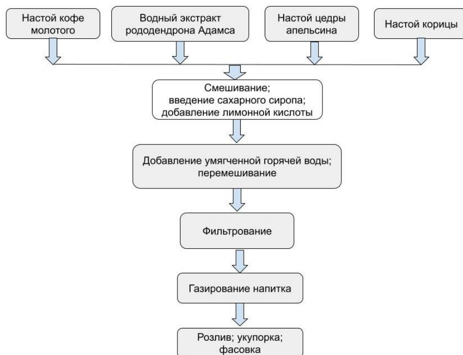
Рис. 2. Технологическая схема производства питьевого продукта «Напиток от Сагана» на основе экстракта рододендрона Адамса
