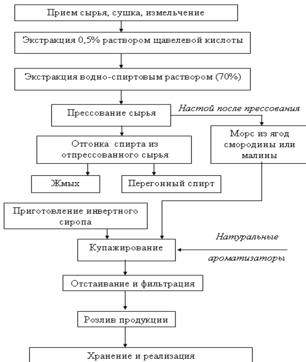
Рис. 1. Технологическая схема получения ликера на основе культивируемого ягодного сырья
