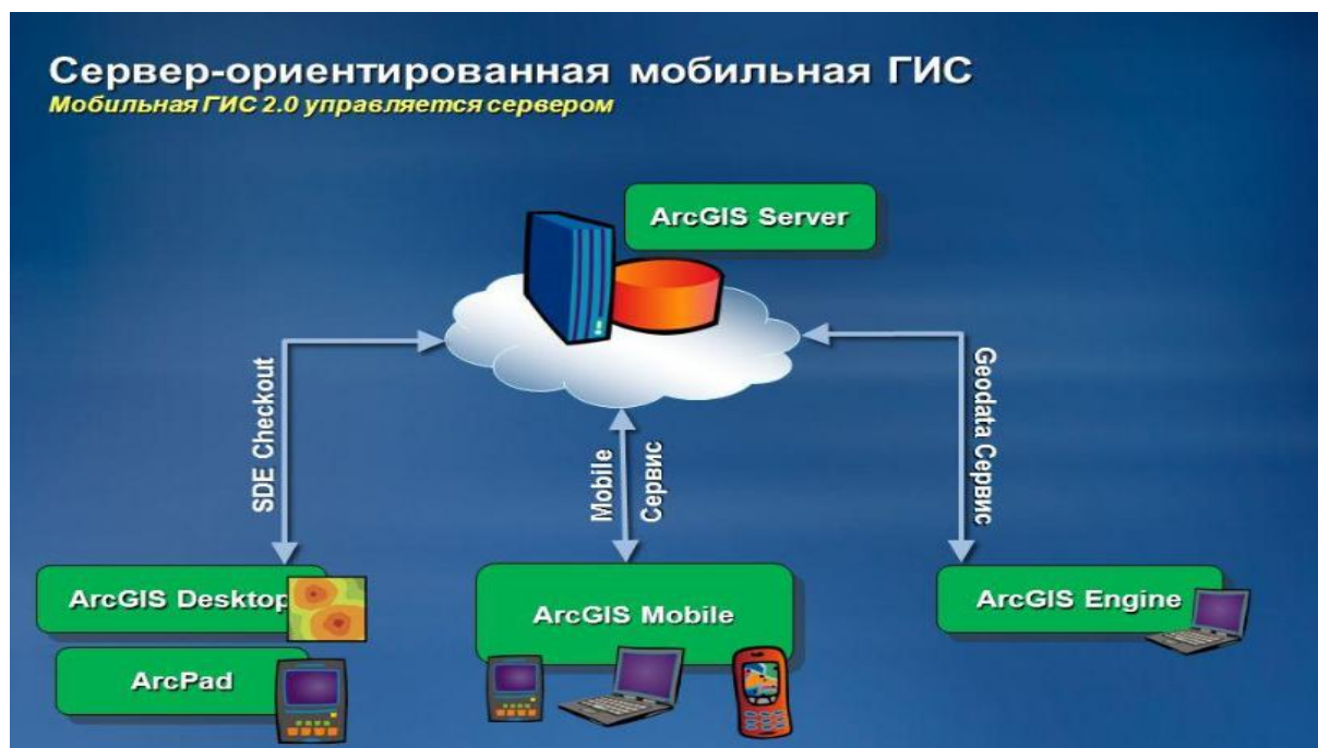
Рис. 2. Система взаимодействия мобильных приложений и устройств с ArcGIS Server [5]
