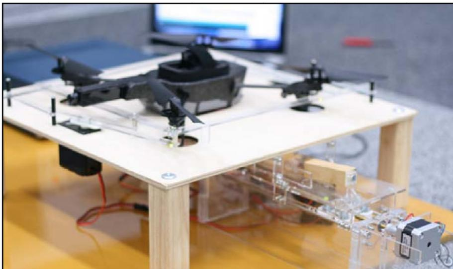
Рис. 2. Автоматизированная посадочная платформа Endless Flyer для замены батареи квадрокоптера Parrot AR Drone [5]
