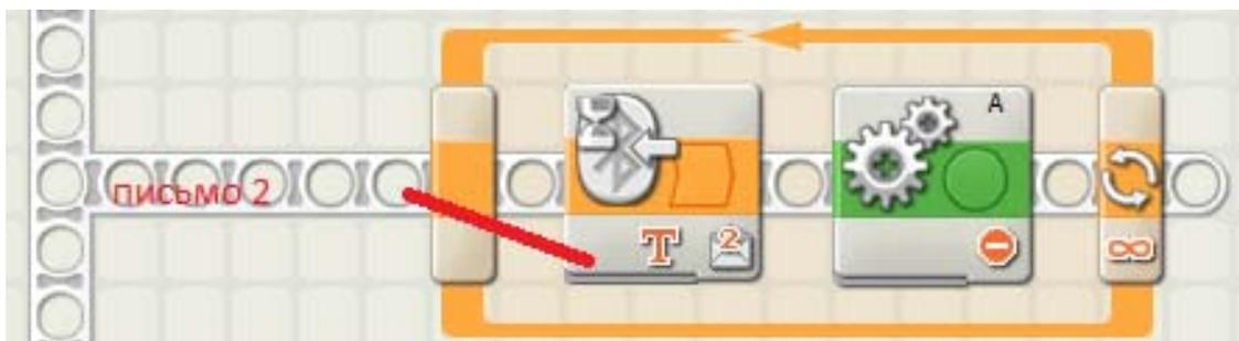
Рис. 5. Считывание данных о мощности мотора из переменной
