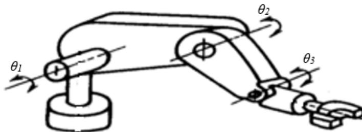
Рис. 1. Конструкция промышленного манипулятора
