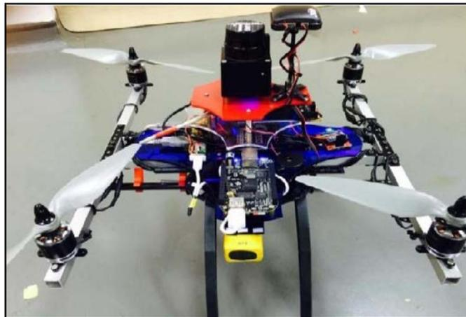
Рис. 3. Вид БПЛА с бортовыми сенсорами и электроникой для автономной посадки на заряжающую посадочную площадку [6]
