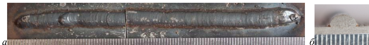
Рис. 9. V_{II} = 53,7 м/ч; I_D = 21 А; U_D = 24 В; V_{св} = 3,75 м/ч
