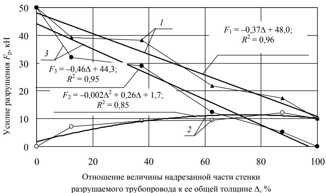
Рис. 3. Результаты исследования различных схем разрушения отработавших трубопроводов: 1, 2, 3 – усилия соответственно суммарные, разрезания и разрыва для стального трубопровода с диаметром d_c = 0,068 м и толщиной стенки \delta_c = 0,004 м
