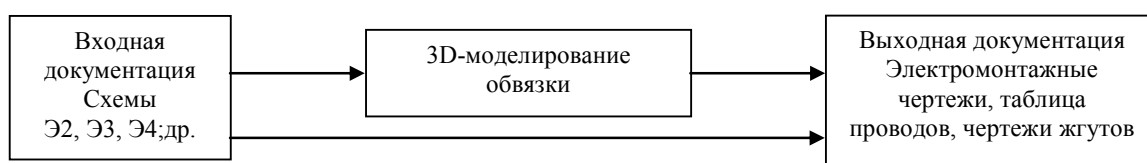
Рис. 1. Основные стадии проектирования кабельно-жгутовой обвязки изделия
