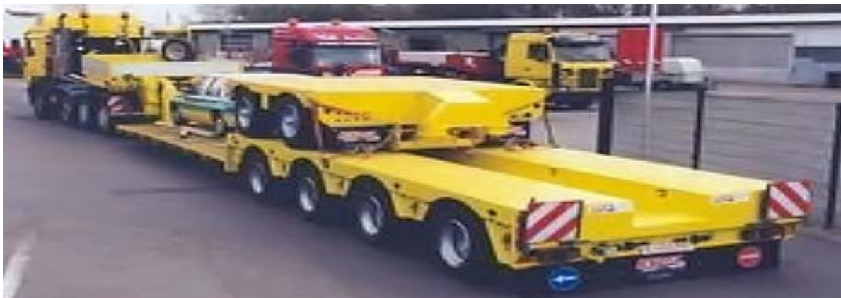
Рис. 3. Строительный трал Nootboom 40/60 т
