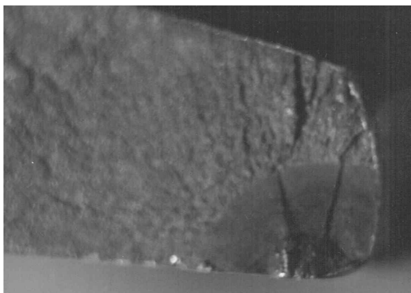
Рис. 2. Поверхность разрушения вблизи очага зарождения трещины, х 5
