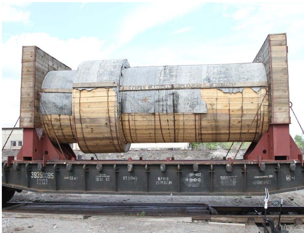
Рис. 1. Перевозка турбинного вала массой 96 т для Саяно-Шушенской ГЭС
