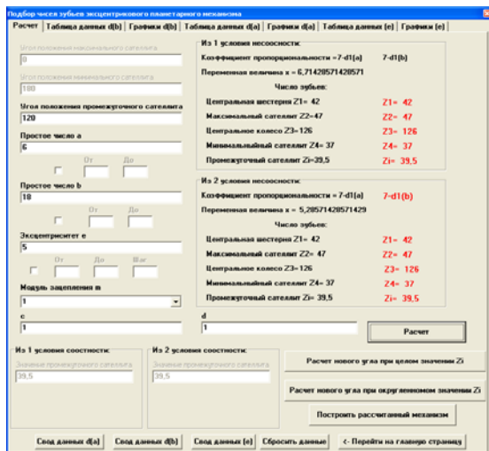
Рис. 4. Вид окна «Подбор чисел зубьев эксцентрикового планетарного механизма»
