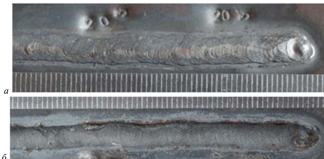
Рис 4. Наплавленный валик (а) и его обратная сторона (б). Толщина образца 0,5 мм; V_{II} = 53,75 м/ч; I_D = 12 А, U_D = 19 В; ; V_{св} = 3,7 м/ч
