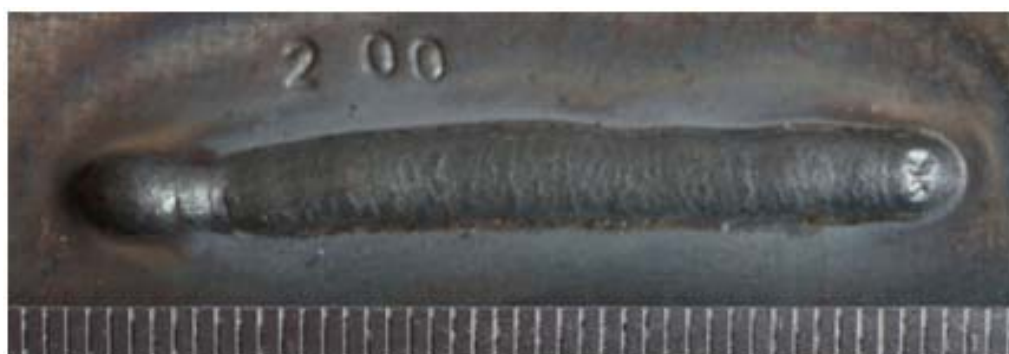
Рис. 5. Валик, наплавленный на сталь толщиной 0,8 мм; V_{II} = 61,2 м/ч; I_D = 15 А; U_D = 19 В; V_{св} = 3,7 м/ч
