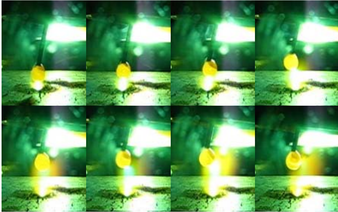
Рис. 1. I_d = 4,5 \text{ A} , U_d = 25-30 \text{ B}
